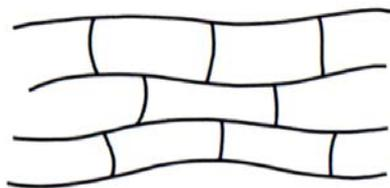
Die senkrechten Vernetzungseinheiten zwischen den langen waagerechten Siliconketten lassen eine gewisse Verschiebung innerhalb der Struktur zu. Daher ist das Material elastisch.
